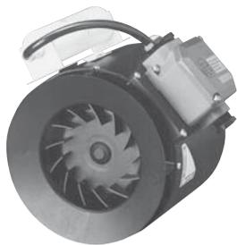
Diese Serie eignet sich zum Einbau zwischen zwei Rohren bei minimalem Platzbedarf. Ansaug- und Abluftstutzen entsprechen den gängigsten Rohrdurchmessern, explosionsgeschützte Ausführung  $\text{Ex II 2G Ex eb h IIB+H}_2 \text{ T}_3 \text{ Gb}$  (DRK 160 EX: T4).
