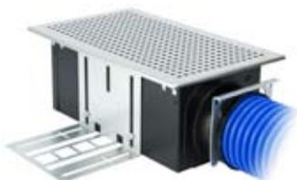
Der Fußboden- und Wandauslass FBA 75 ist als Quellauslass konzipiert und besteht aus einem Kunststoffgehäuse mit eingebauter Mengenregulierung, einem integrierten Schallabsorbitionselement, einem Filter bei Einsatz als Abluftelement, einem Anschlussstutzen zum Anschluss des Luftverteilschlauches LVS 75 A sowie verstellbarer Befestigungswinkel für die einfache Montage und Anpassung an das fertige Fußbodenniveau.
