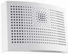
Der Wernig Designauslass WDZA vereint ein Element für Zuluftzuführung als auch Abluftabführung für Wandeinbau. Die Volumenstromereinstellung erfolgt ganz einfach durch die standardmäßig mitgelieferten „Ein-Klick“-Abdeckstreifen. Die Elemente sind mit Anschlussdurchmesser DN 100 und DN 125 lieferbar und können auf Grund der serienmäßigen Doppellippendichtung ohne weitere Befestigungsmaßnahmen in die entsprechenden Rohrleitungen eingeschoben werden.
