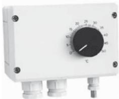
Der elektronische Zweipunktregler erfasst mit einem im Gehäuse integrierten Temperaturfühler die Isttemperatur an einem Messort und schaltet in Abhängigkeit der Abweichung zur Solltemperatur ein Relais. Weicht die Isttemperatur von der eingestellten Solltemperatur ab, schaltet ein potentialfreier Kontakt um. Die Schaltdifferenz ist intern von 0,5 bis 5 K verstellbar. Über eine interne Steckbrücke kann zwischen der Funktion „Heizen“ oder der Funktion „Kühlen“ gewählt werden.
