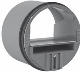
Konstantvolumenstromhalter zum Einschieben in Lüftungsrohre. Der KVH stabilisiert die vorgegebene Nennluftmenge in einem Differenzdruckbereich von ca. 50–200 Pa.
