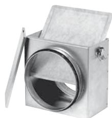
In der Filterbox FBR ist eine Filtermatte der Klasse ISO Coarse  $\geq 50\%$  (G3) eingebaut, welche mehrmals gereinigt werden kann (passende Ersatzfilter siehe Tabelle). Das Gehäuse besteht aus verzinktem Stahlblech und hat Rohrstützen mit Gummidichtungen sowie einen Deckel mit zwei Schnellverschlüssen.
