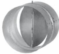
aus Metall, mit Feder, öffnet sich selbsttätig bei Inbetriebnahme des Ventilators und schließt bei Außerbetriebnahme, zum Einbau zwischen Lüftungsrohren.
