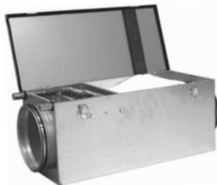
Pumpenwarmwasserheizregister für Rohreinbau zur Lufterwärmung in Lüftungssystemen. Heizregister und Taschenfilter sind in einem kompakten Gehäuse montiert.
