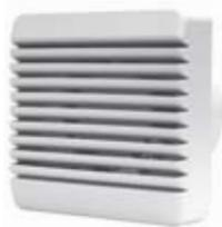
Universelle Ventilatoren mit optisch ansprechender Formgebung für die Entlüftung kleiner Räume wie z.B. Bad, WC, Abstellräume usw., überall dort wo kleine Lufraten gewünscht werden, in jeder Lage einbaubar. Strahlwassergeschützt, Schutzart IP45, Schutzklasse II, geeignet zum Einbau in Schutzbereichen 1 und 2 von Dusche und Badewanne.
