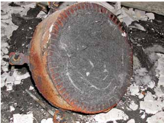
Brandschutzmanschette BSM nach 90 Minuten Brandversuch
